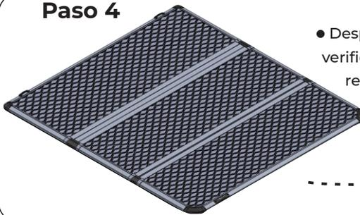
● Desplegar la tercera falange (lado compuerta), verificar posición, ajustar topes laterales con su respectiva herramienta (llave Torx T40) y luego ajuste con sus cierres.
